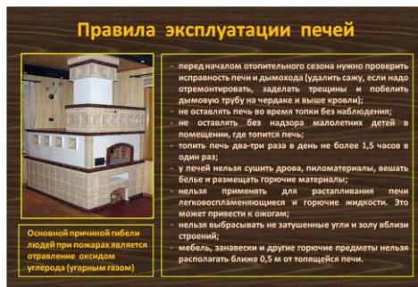
Например, в печи появились трещины. С течением времени они становятся больше, во время топки через них начинают пробиваться искры, а потом и язычки пламени. И если трещины появляются в тех местах, где к печи примыкают деревянные перегородки или перекрытия, это неминуемо приводит к пожару. Появившиеся трещины надо немедленно затирать. Перед каждым отопительным сезоном необходимо побелить печи и дымоходы.
